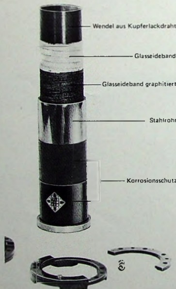
Bild 1. Weitverkehrs-Wendelhohlleiter mit Kupplung (AEG-Telefunken)
